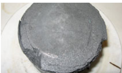
Abb. 2 Foto einer Probe des abgebindenen Verpressmaterials nach Frost/Tau-Wechselbeanspruchung (mit Dehnungsbehinderung gefroren)
