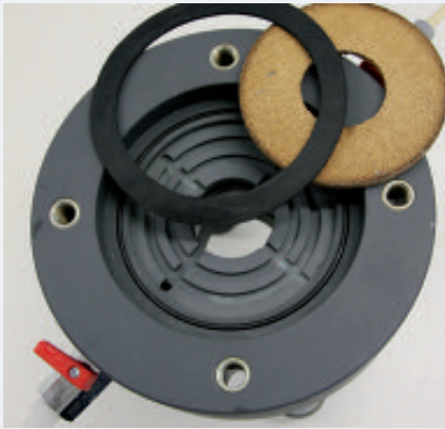
Abb. 1 Fußplatte der Messzelle mit Filterstein und Dichtring
