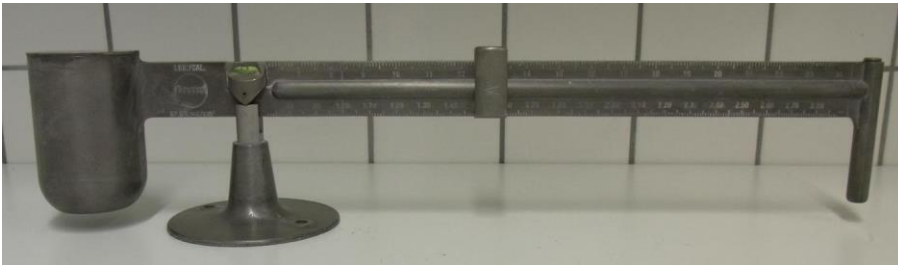
Abb. 3: Spülungswaage zur Bestimmung der Dichte von Hinterfüllsuspensionen.
