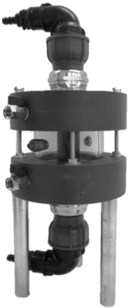
Abb. 6: Messzelle zur Bestimmung des Einflusses von zyklischen Frost-Tau-Belastungen auf die Systemdurchlässigkeit von Hinterfüllbaustoffen für EWS.
