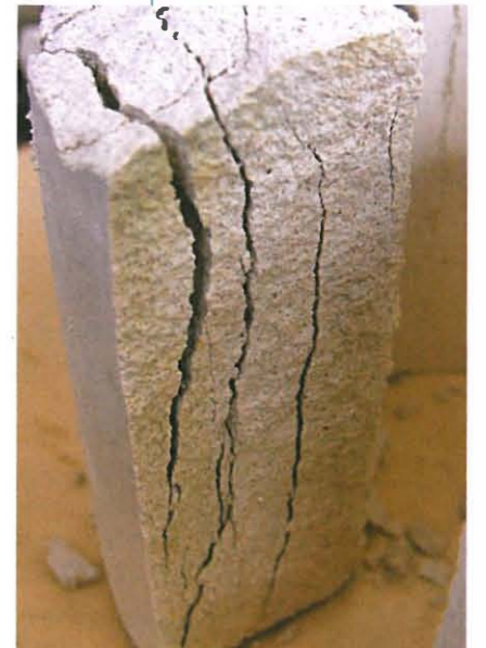
▲ Prüfkörper eines handelsüblichen Hinterfüllmaterials nach sechs Frost-Tau-Wechseln
