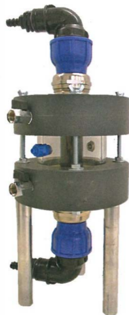
▲ Wasserdurchlässigkeitszelle für die Frost-Tau-Versuche
