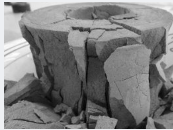
Abb. 10 Prüfkörper mit 28 Tagen Abbindezeit nach zwei Frost-Tau-Wechseln und anschließender Trocknung im Trockenschrank
