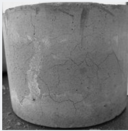
Abb. 9 Gitterartige Rissstruktur eines Prüfkörpers mit 56 Tagen Abbindezeit nach 9 Frost-Tau-Wechseln
