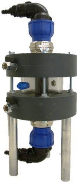
Abb. 8: Frank-und-Anbergen-Messzelle zur Bestimmung der Systemdurchlässigkeit und des Frost-Tau-Wechselwiderstands (nach Anbergen et al. 2011).
