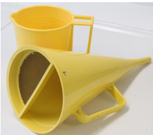
Abb. 4: Marsh-Trichter zur Bestimmung der Trichterauslaufzeit von Hinterfüllsuspensionen (DGG & DGGT 2014).
