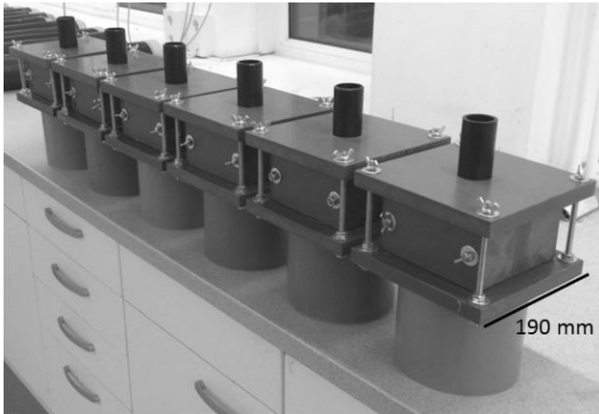
Abb. 7: Gießanlagen für die Herstellung von Prüfkörper für Systemdurchlässigkeits- und Frost-Tau-Wechsel-Versuche (Anbergen et al. 2014).
